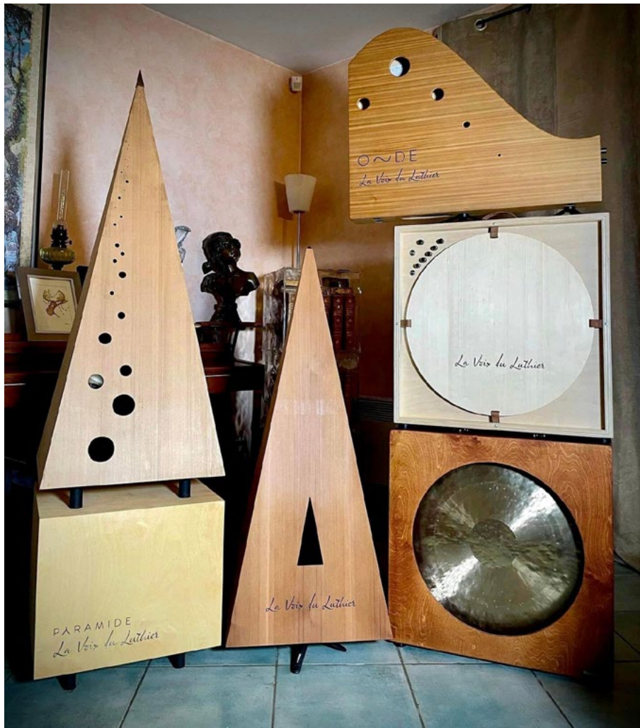
Différents types de diffuseurs sans haut parleur à membrane. En bas à droite, le gong diffuseur métallique Martenot . Autour, des diffuseurs en bois de la marque La Voix du Luthier .
